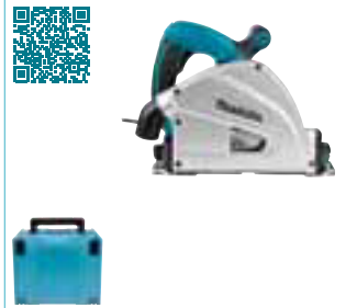
SP6000J 1300 W - Ø 165 mm - capacités de coupe à 90°/45°/48° : 56/40/38 mm - 4,4 kg Livrée avec 1 lame carbure bois B-07353 en coffret MAKPAC
