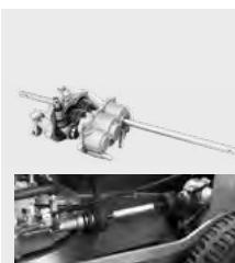
Pour ces 5 tondeuses pro-édition, transmission professionnelle à 3 vitesses entraînée par cardan. Avec son nouveau système d'ajustement rapide, le guidon entièrement repliable facilite le transport et le stockage mais aussi le nettoyage du carter de coupe en position verticale.
