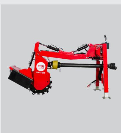
Grâce à son bras à levage hydraulique, à l'extension et l'inclinaison de la tête de coupe et à une protection contre les copeaux réglable, la FSI T65 est un outil extrêmement efficace pour les travaux de dessouchage. Disponible pour les tracteurs de catégorie 2 de 70 à 120 ch.
