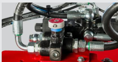
Le débit hydraulique du balayage peut être ajusté si nécessaire pour s'adapter à différents niveaux de dureté du bois.
