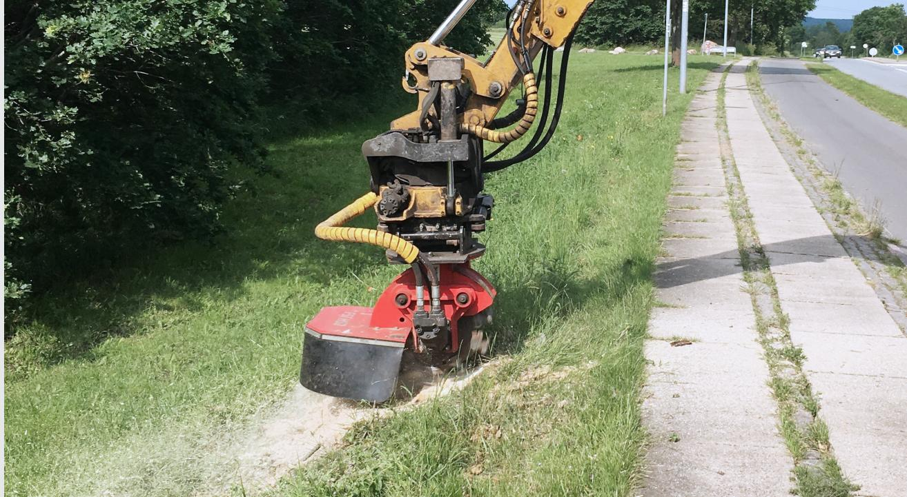
Augmentez la fonctionnalité de votre excavatrice en y ajoutant un accessoire de dessouchage à moteur hydraulique, idéal pour les zones difficiles d'accès telles que les pentes, les berges, ou l'arrière des clôtures et des murs de pierre. Notre gamme est adaptée aux excavatrices de 2 à 20 tonnes (15 à 160 ch).
