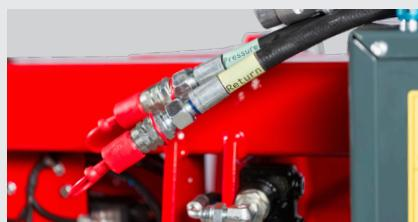
Les connecteurs hydrauliques et électriques sont inclus et clairement identifiés pour une manipulation correcte.
