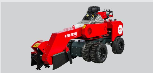
La FSI B38 4WD à quatre roues motrices reprend les caractéristiques du modèle 2WD, mais propose également l'entraînement FSI power-drive, un système d'entraînement au sol à 2 vitesses. Ce système permet à l'opérateur de choisir entre le réglage 2WD HI pour les déplacements sur de longues distances à vitesse élevée et 4WD LOW pour une meilleure traction lors des déplacements sur le terrain et le rognage de souches.
