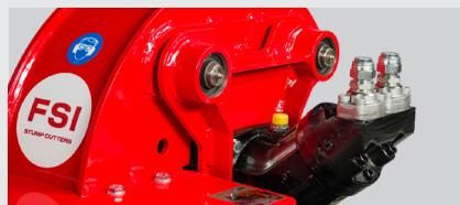
Un support de moteur flottant avec amortisseurs de vibrations intégrés réduit les contraintes sur la structure.
