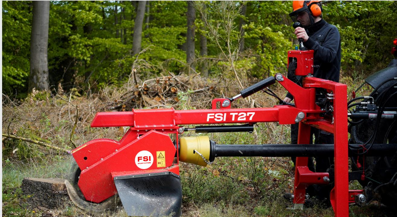
Les rogneuses de souches FSI montées sur tracteur sont idéales pour les opérations de défrichement, le retrait de souches dans les vergers, les travaux municipaux dans les parcs ou le long des chemins et des routes. Ces rogneuses de souches tirent parti de la puissance du tracteur et de ses capacités en tout-terrain pour éliminer efficacement plusieurs souches en peu de temps, ce qui les rend parfaites pour les travaux de grande envergure dans les zones d'accès libre.
