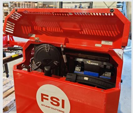
Un compartiment arrière verrouillable permet de ranger la télécommande et de protéger les points de remplissage contre tout accès non autorisé.
