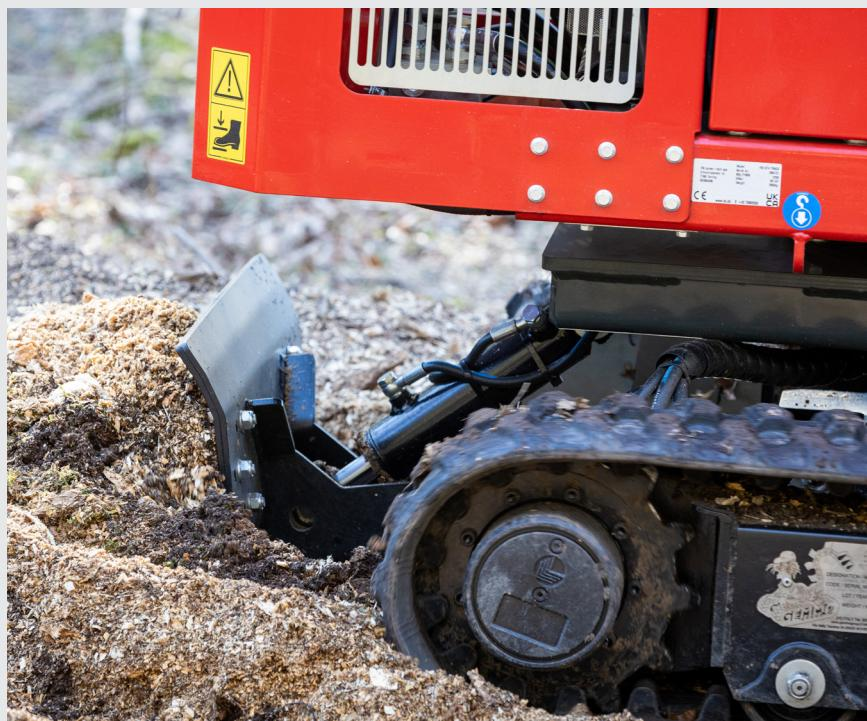
La lame de remblayage facultative facilite le niveling du sol et le remblayage après le dessouchage, ce qui permet d'obtenir un chantier plus propre et d'aspect professionnel.
