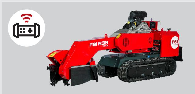
Comme la FSI B38 4WD REMOTE, le modèle TRACK dispose d'un système de commande à distance offrant toutes les fonctions à portée de main pour le rognage de souches. Un ensemble de chenilles contre-rotatives offre une maniabilité et une traction élevées sur les terrains difficiles, et peut être rétracté pour permettre le passage par des portails de jardin étroits.
