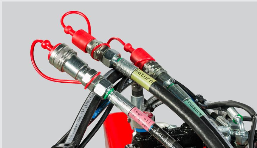
Veuillez noter : les rogneuses de souches hydrauliques FSI doivent être équipées d'un raccord de retour à écoulement libre.
